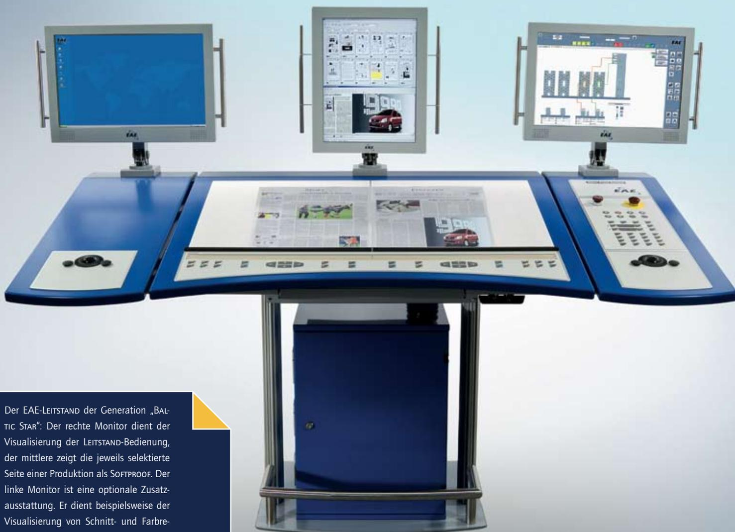
Der EAE-LEITSTAND der Generation „BALTIC STAR“: Der rechte Monitor dient der Visualisierung der LEITSTAND-Bedienung, der mittlere zeigt die jeweils selektierte Seite einer Produktion als SOFTPROOF. Der linke Monitor ist eine optionale Zusatzausstattung. Er dient beispielsweise der Visualisierung von Schnitt- und Farbgisterregelungen.
