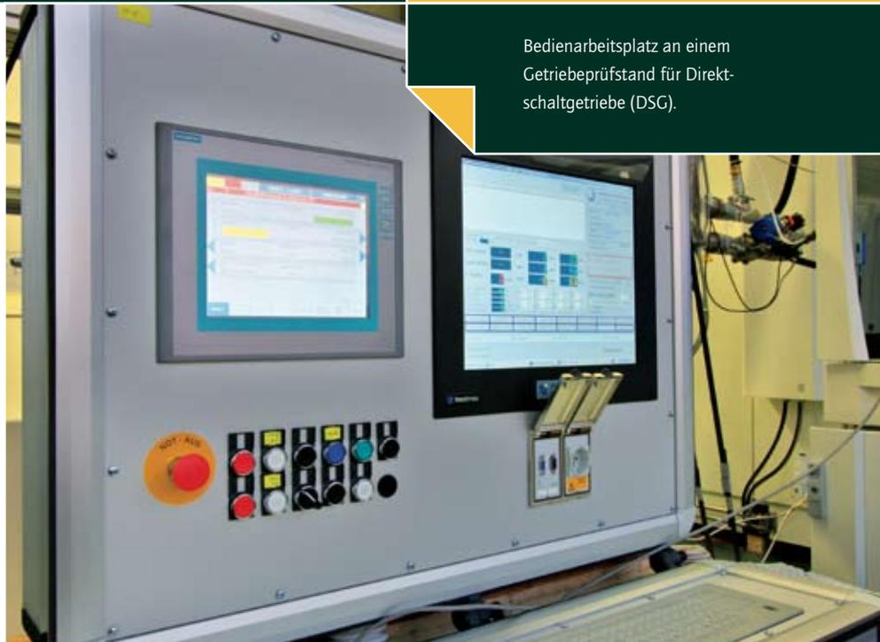
Bedienarbeitsplatz an einem Getriebeprüfstand für Direkt-schaltgetriebe (DSG).
