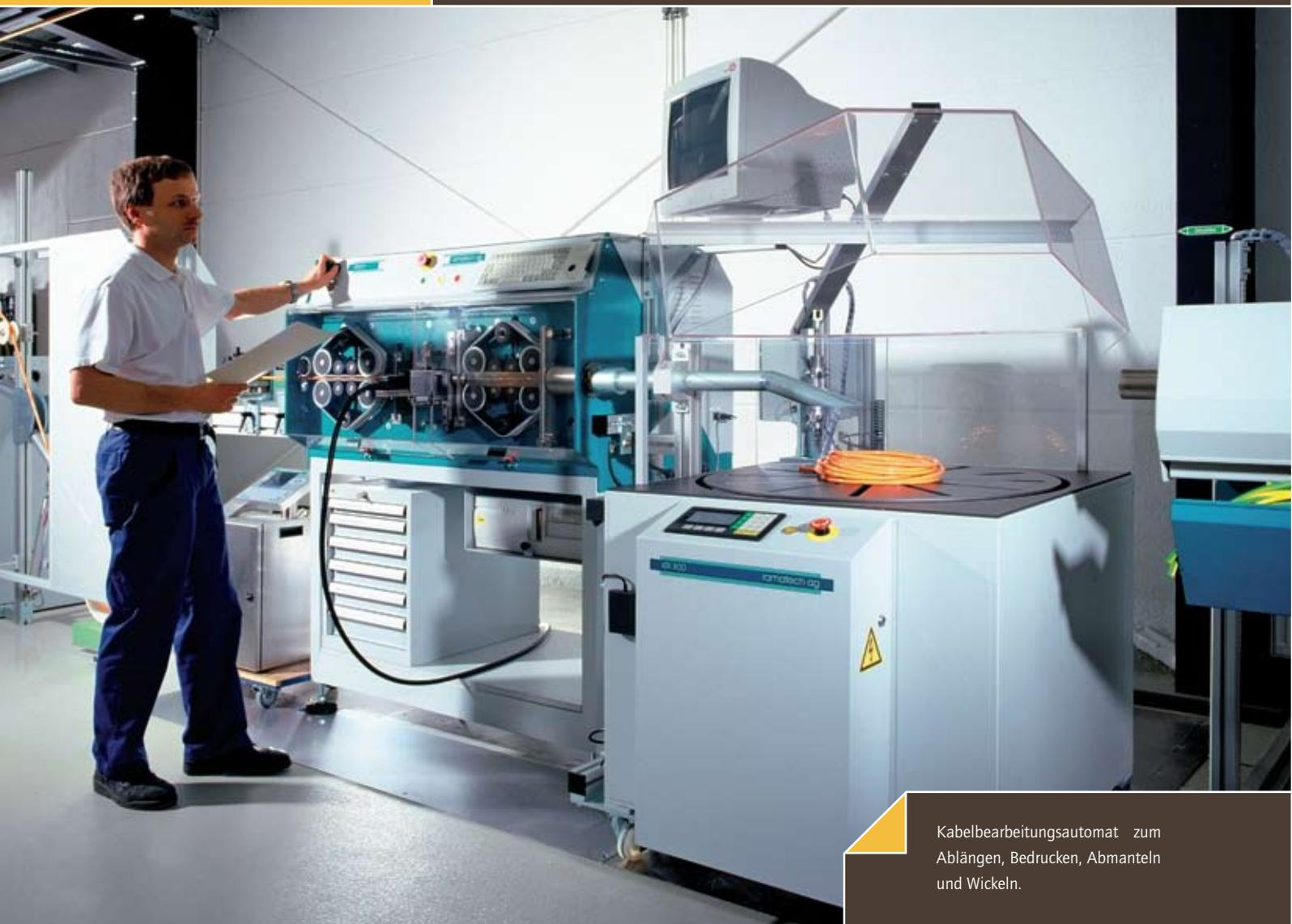
Kabelbearbeitungsautomat zum Ablängen, Bedrucken, Abmanteln und Wickeln.
